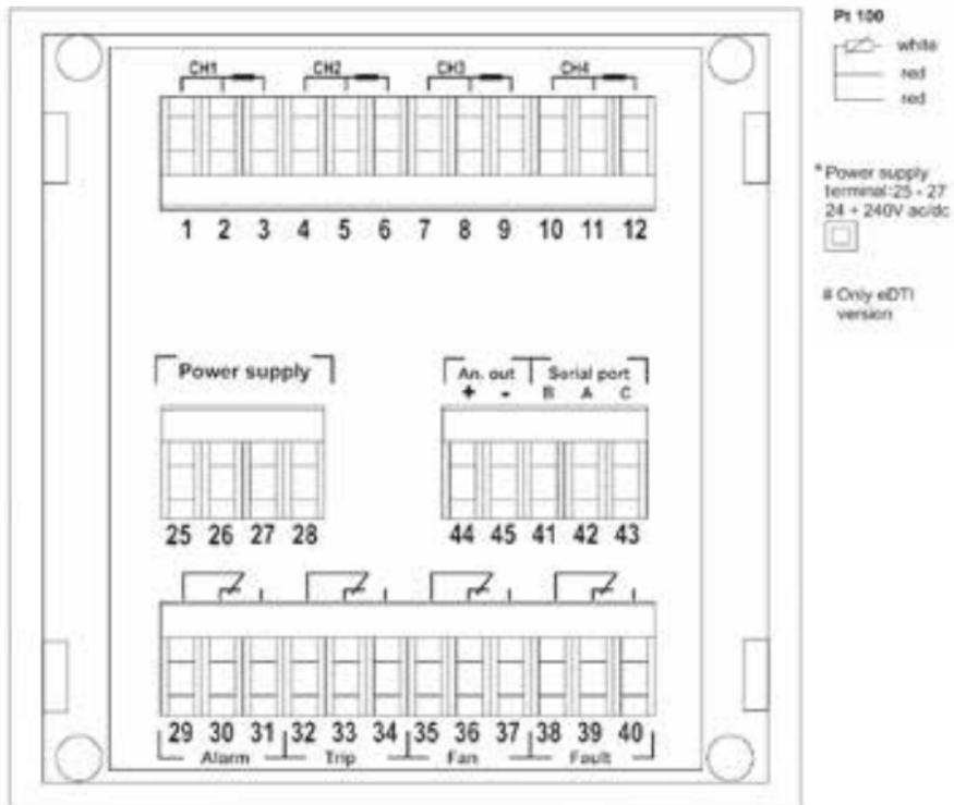
Vista del panel trasero del instrumento con los terminales para las conexiones
