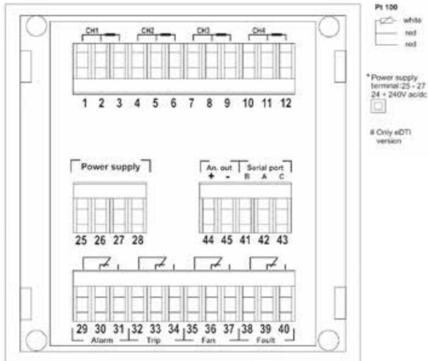
Vue du panneau arrière de l'instrument avec bornes pour les connexions
