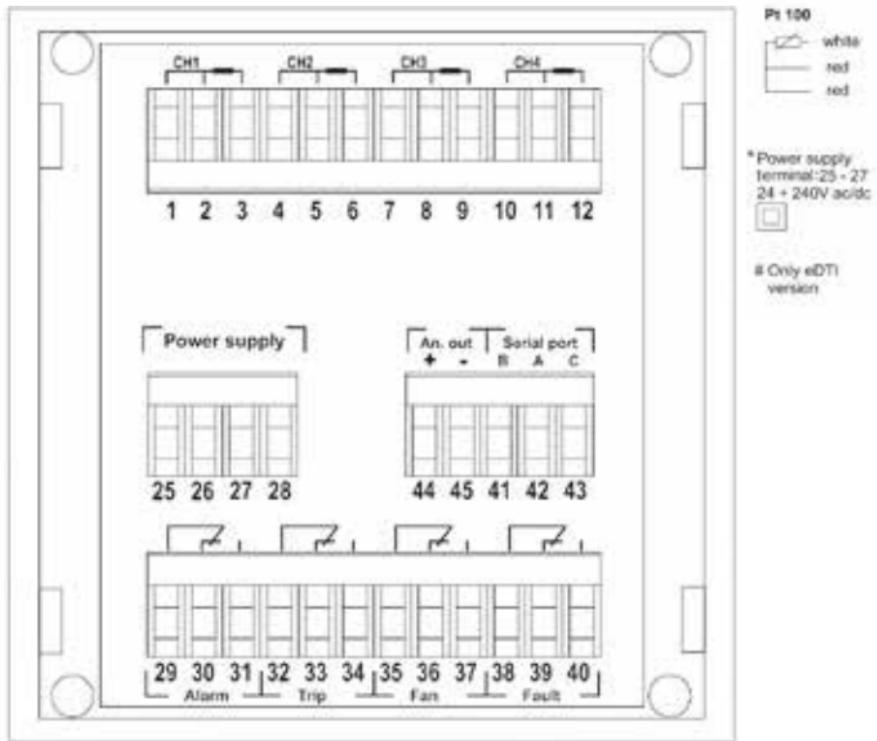
Vista posteriore del dispositivo con tutte le connessioni necessarie.
